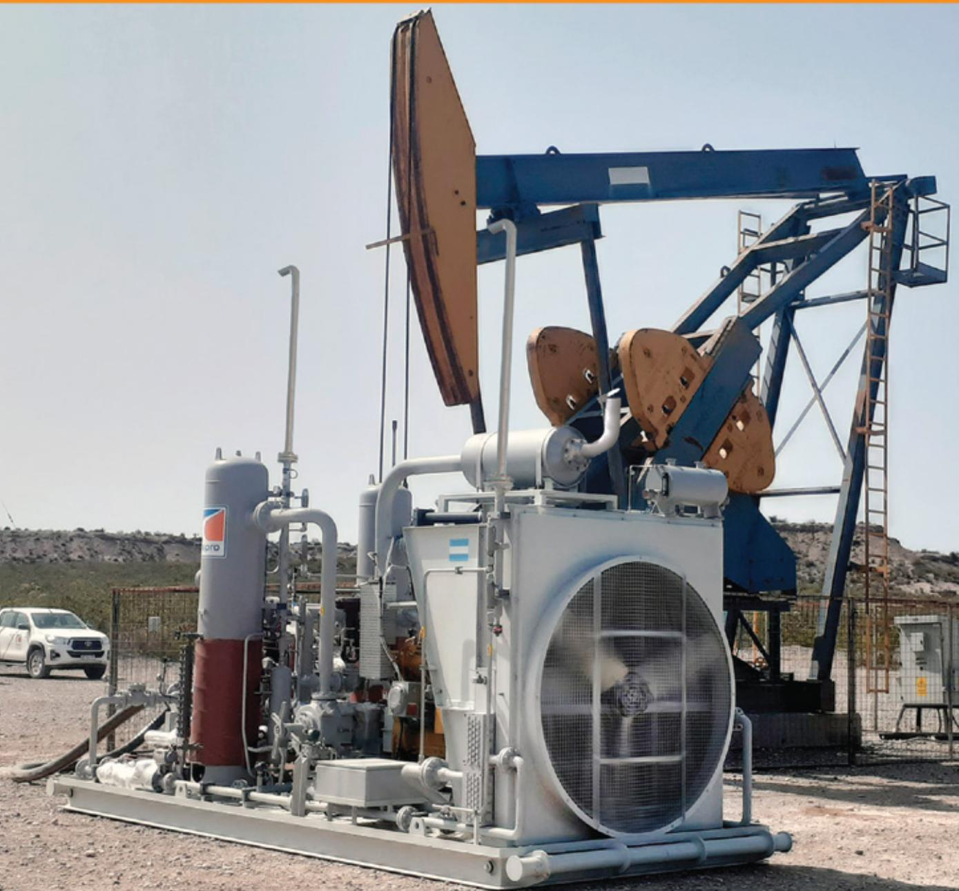
Cuenta con una válvula de control de presión a la entrada para regular la presión en la succión del equipo. Funciona como válvula de cierre rápido SHUT DOWN para aislar la máquina del pozo o gasoducto.
